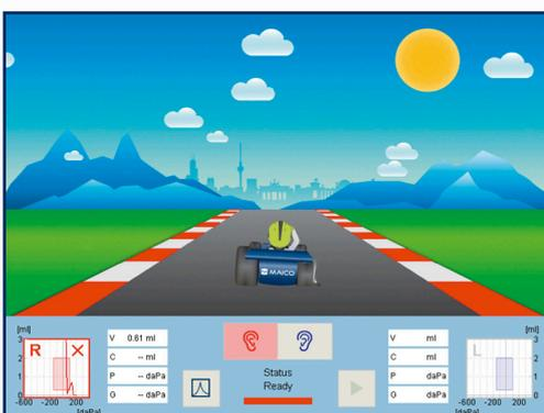
3. Dichtet der Ohrstöpsel nicht richtig ab oder bewegt das Kind den Kopf, stoppt das Rennauto mit einer Reifenpanne und die Messung muss wiederholt werden.
